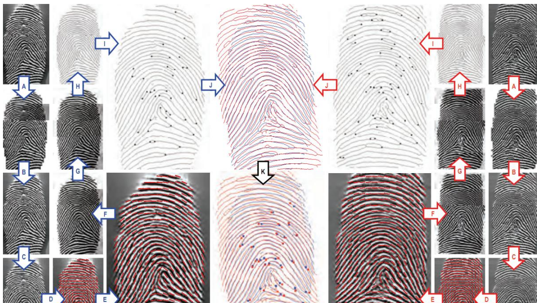
Abb. 7: Ergebnisse der einzelnen Bildverarbeitungsschritte zur Merkmalerkennung der gespeicherten Bilder (blau) und der Anfrage (rot) zum Merkmalsvergleich [Fons und Fons (2011)]
