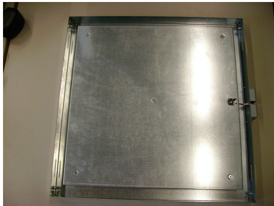
20.1: Plattenelektrode von Rode Melder (Aufbau 1)
