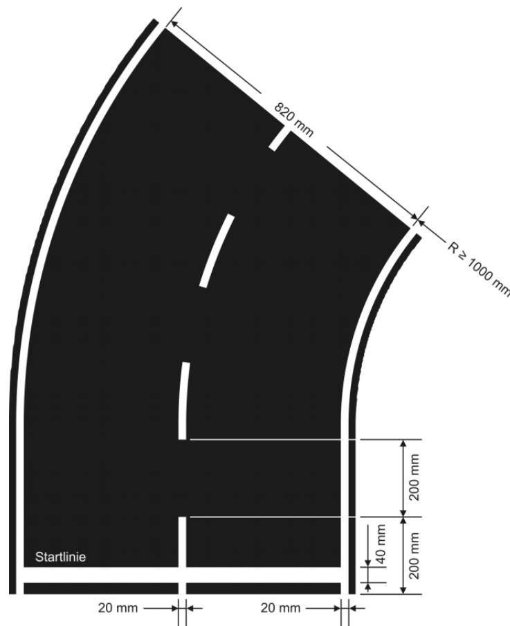
Abbildung 1.1: Fahrspur-Geometrie im [Carolo-Cup-Regelwerk 2011]
