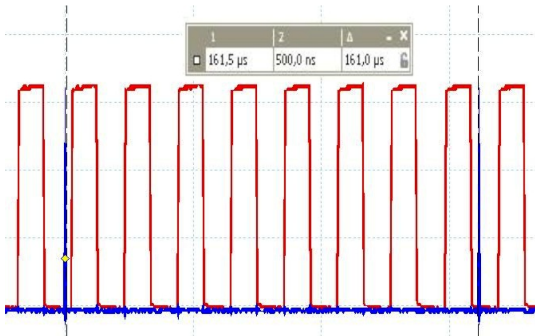
Abbildung 41: Zeitbedarf einer FIR-Stereo-Filter-Aktualisierung über die FSL-Schnittstelle im laufenden Betrieb
