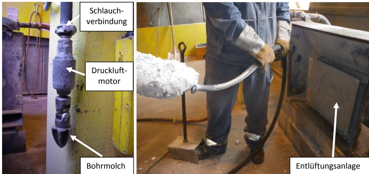
Bild 5-2 Bohreinheit
