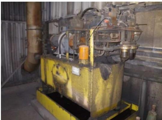
Bild 7-5 Hydraulikaggregat
