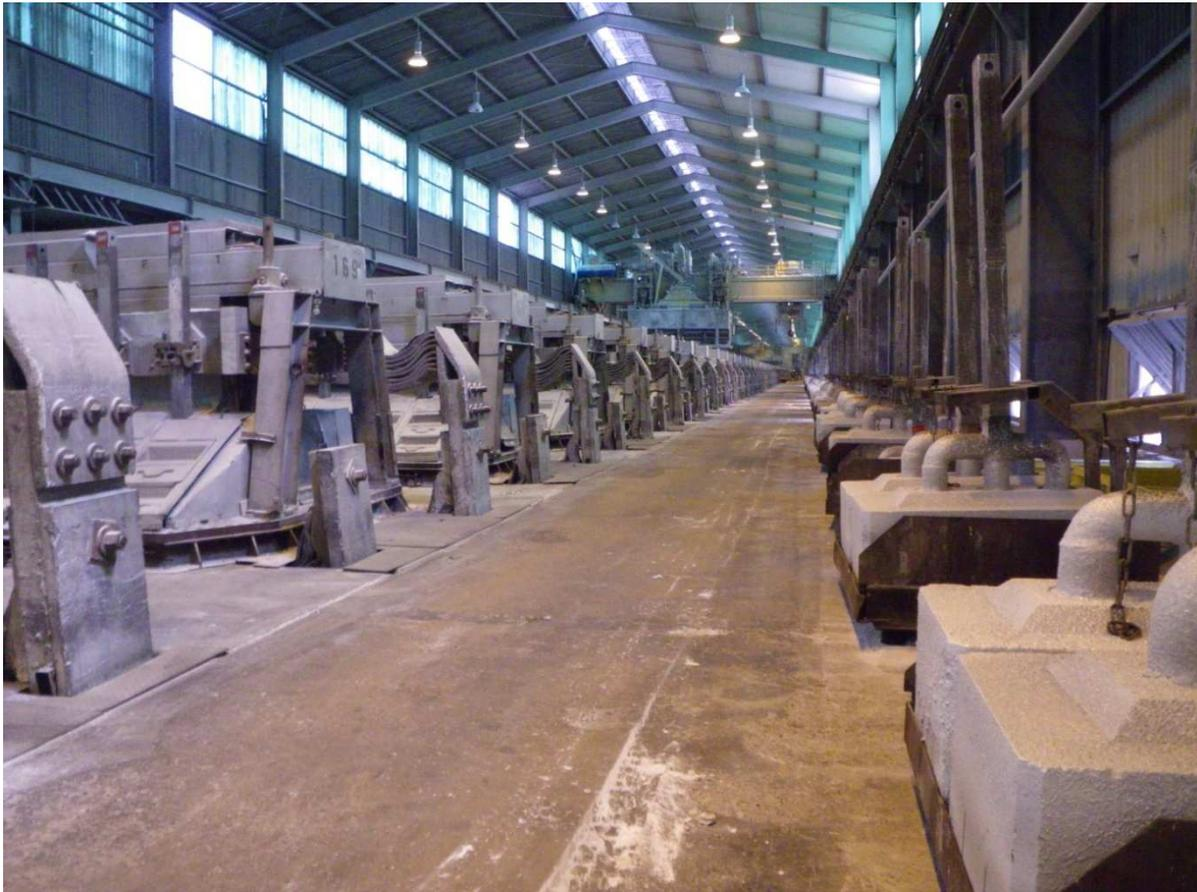
**Bild 2-2 Elektrolysehalle (links: Zelle, rechts: Anoden)**
