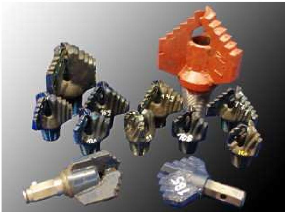
Abbildung 2 Dreiflügelmeißel mit verschiedenen Anschlüssen
