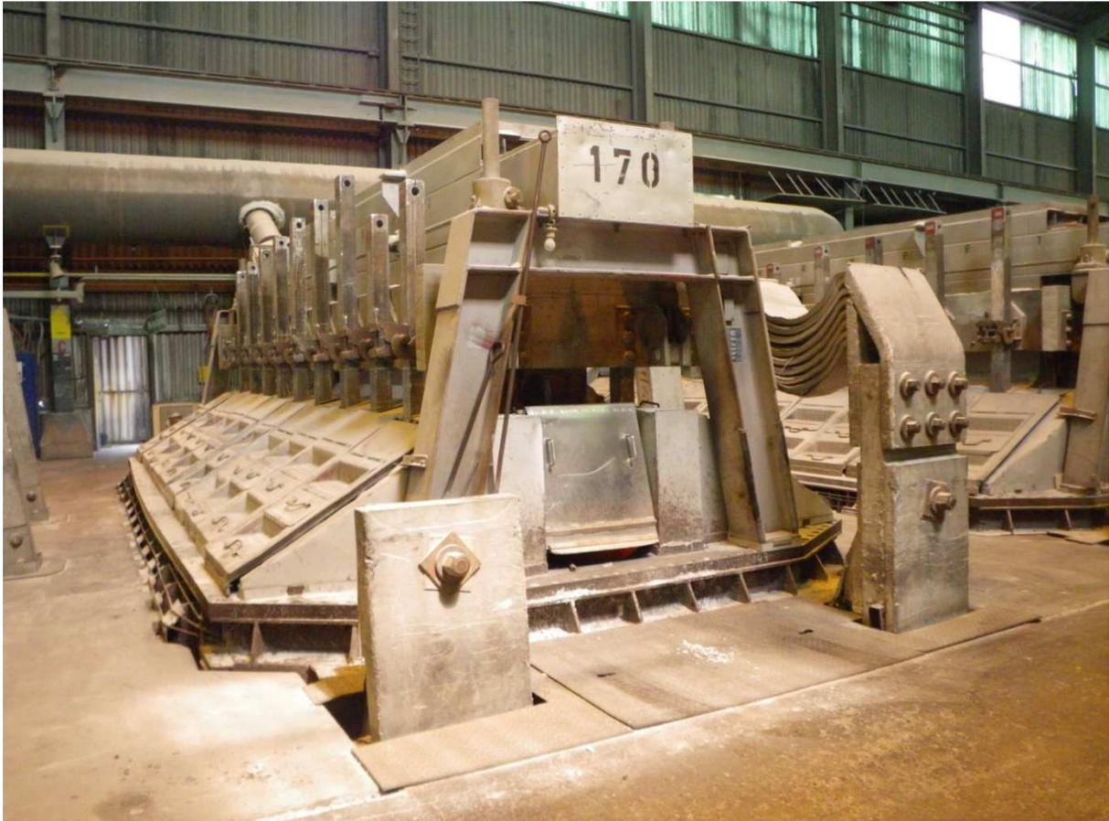
Bild 2-6 Elektrolysezelle
