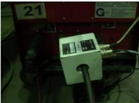
Abb. 17: Prozesssensor am Masseanschluß
