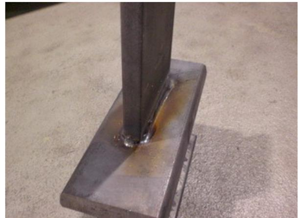
Abbildung 5.14: Schweißnahtverbindung Probe 6.3
