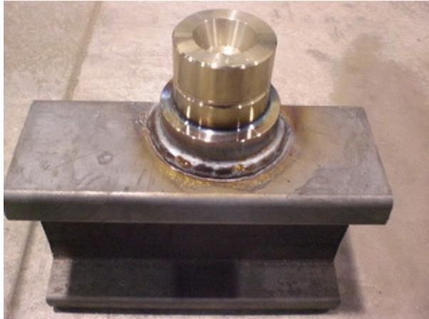
Abbildung 5.11: Schweißnahtverbindung Probe 6.1
