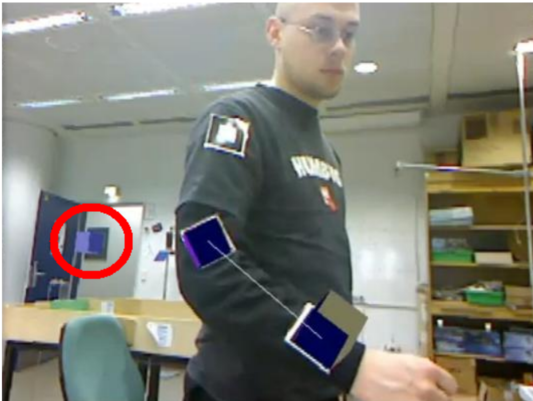
Abbildung 4.23.: Fehlererkennung einer Markers bei dem ARToolkit
