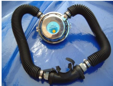
Abbildung 1.1: Zweischlauchautomat der Firma Dräger
