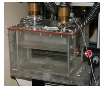
Abbildung 3.6: Luftbefeuchter mit Wärmetauscher
