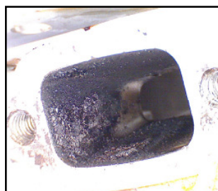
Abbildung 78 Verkockung am Auslasskanal des zweiten Zylinders
