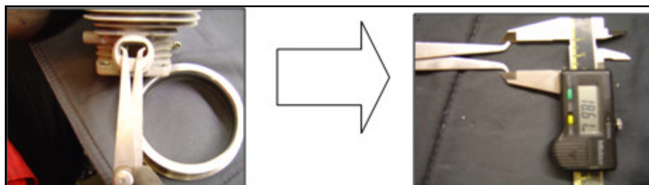
Abbildung 56 Messung des Auslasskanals
