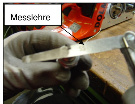
Abbildung 66 Messung des Zündkerzenabstandes
