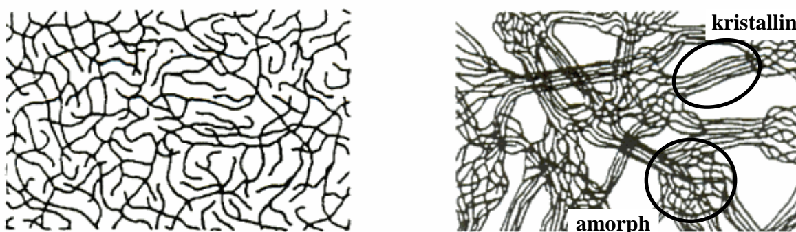
Abbildung 1: Schematische Darstellung der Molekülstruktur von amorphen (links) und teilkristallinen (rechts) Thermoplasten nach [12]
