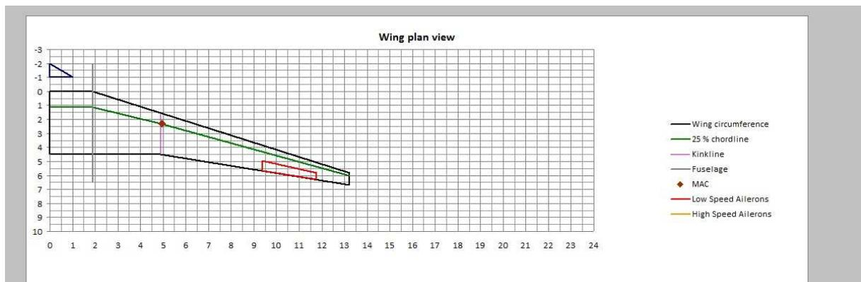
Bild 2.6 Tragflächengrundriss
