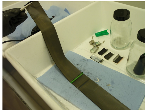
(d) ausgebreitete Anode, mittig der Ableiterkontakt (grün)
