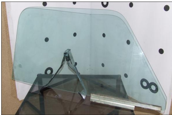
Abbildung 2-5: Seitenscheibe mit einer Klemmschiene
