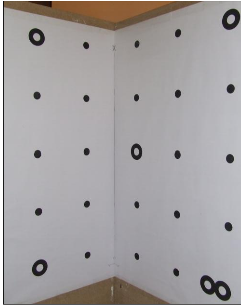
Abbildung 4-2: Kalibrierwände mit Kalibrierpunkten
