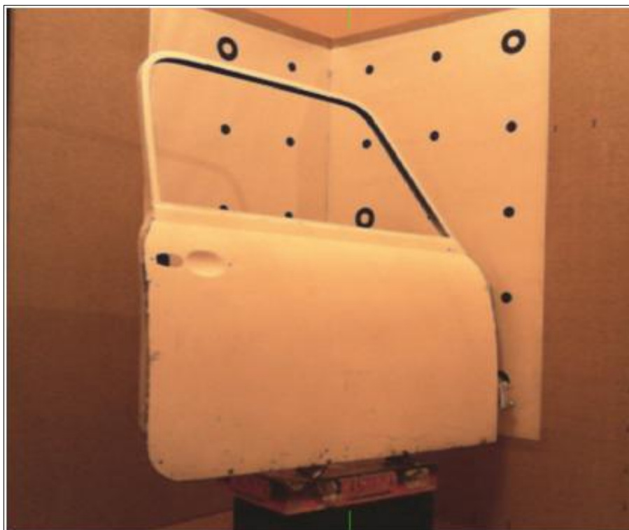
Abbildung 4-9: Ausrichtung der Tür an der Kalibrierwand
