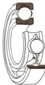
Abbildung 2.10: Beispiel für Rollreibung; einreihiges Rillenkugellager [7]
