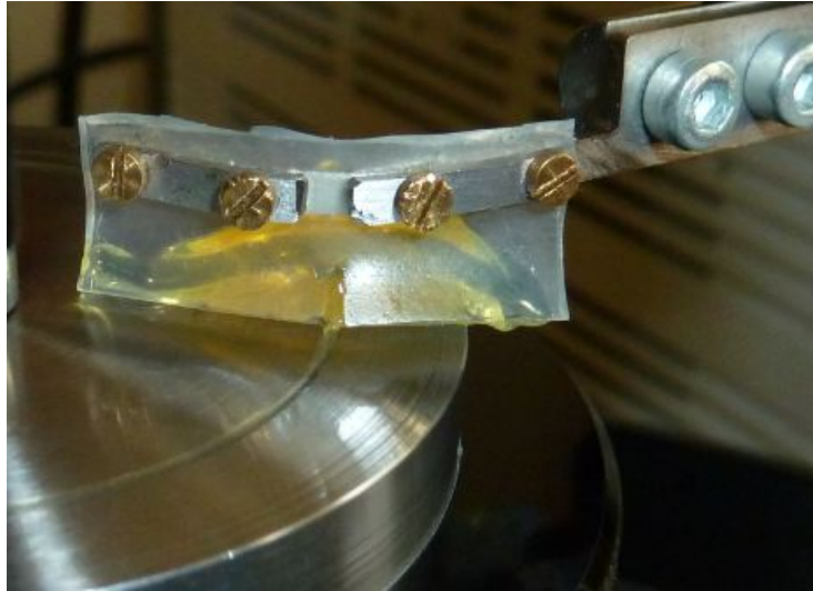
Abbildung 5.2: Abstreifer zur optimalen Schmierfettversorgung [eigene Darstellung]
