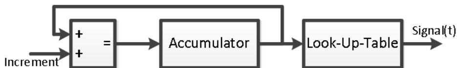
Abbildung 2.6: Struktur eines DDS-Systems
