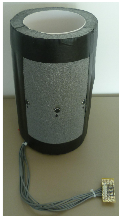
Abbildung 4.4.: Zylindrisches Mikrofonarray mit acht Mikrofonen
