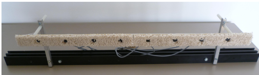
Abbildung 4.3.: Lineares Mikrofonarray mit acht Mikrofonen
