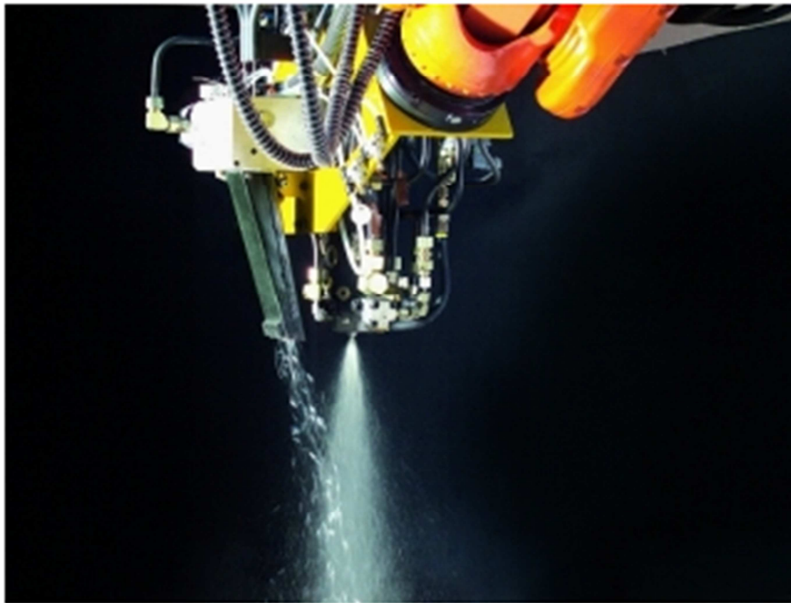
Abbildung 1: PUR-CSM Verfahren (© Hennecke GmbH)
