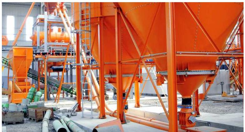
**Abb. 22: Rohrkettenfördersystem der Firma Schrage
