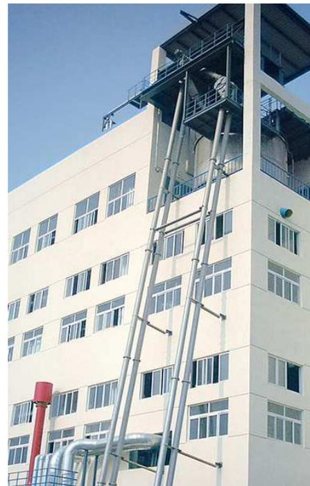
**Abb. 23: Rohrkettenfördersystem der Firma Schrage Rohrketten-system GmbH**
