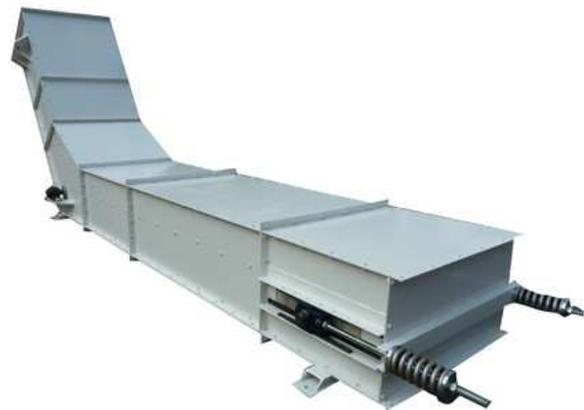
Abb. 12: Trogkettenförderer der Firma Hess Fördertechnik
