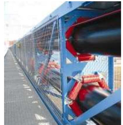
**Abb. 18: Tragrollenstationen einer Rohrgurtförderanlage der Firma FMW Industrieanlagenbau GmbH**
