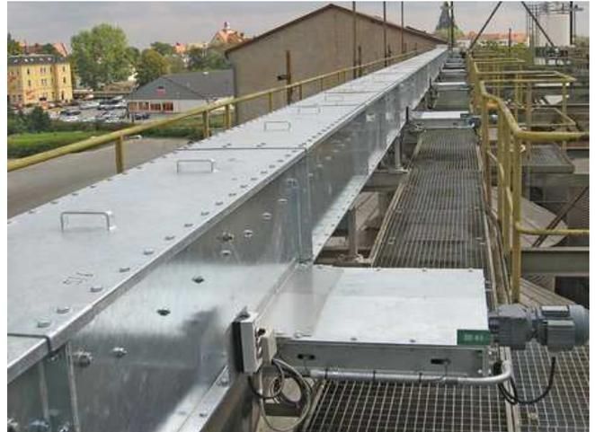
**Abb. 13: Trogkettenförderer der Firma EMDE Industrie-Technik GmbH**
