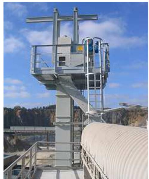
**Abb. 16: Becherwerk mit Wartungsbühne der Firma EMDE Industrie-Technik GmbH**
