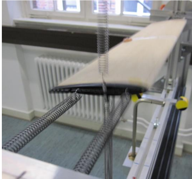
Abbildung 7.10: Momentaufnahme des angeströmten Profils kurz vor dem Flatterfall
