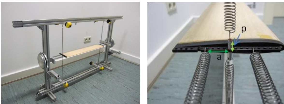
Abbildung 3.4: Fotos des verwendeten Teststands. Zusätzlich sind die Federabstände im Bild (rechts) eingezeichnet.
