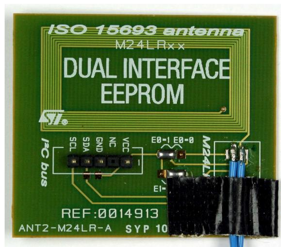
Bild 3.6: Modifizierte Leiterplatte mit Antennenspule (20 × 40 mm) eines Transponders aus dem Entwicklungskit „STARTKIT-M24LR-A“ von ST
