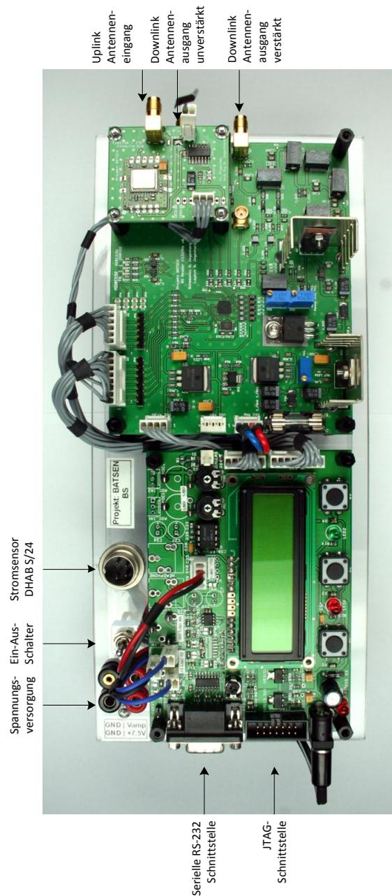
Bild 4.13: Zusammenschaltung der Komponenten zur Reader-Datenlogger-Einheit (Basisstation)
