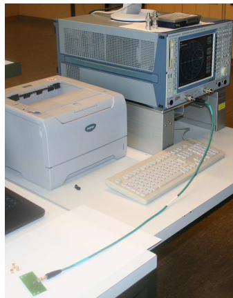
Bild 3.10: Aufbau zur Messung von S_{11}
