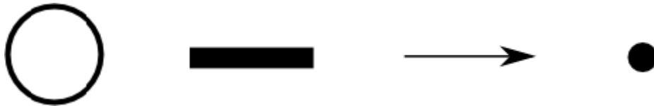
Abbildung 2-1: Petri-Netz-Elemente (Stelle, Transition, Kante und Marke)
