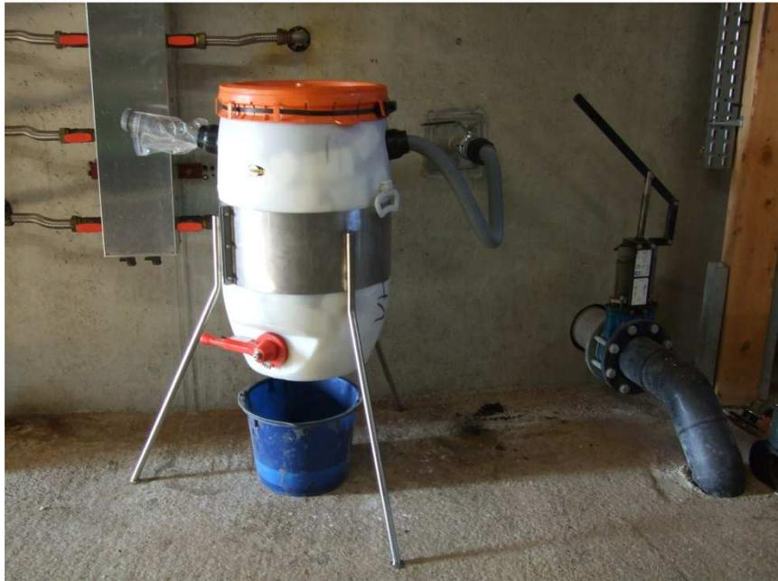
In der der Tonne befindet sich eine weitere Tonne, die über einen Einfüllstutzen mit Biomasse gefüllt werden kann. Unterhalb der Tonne befindet sich ebenfalls eine Öffnung, über die die Tonne wieder entleert werden kann. Das System ist luftdicht verschließbar. Die Proben werden in die Tonne gehängt (Abb. 8.4). So bleiben die Proben in der Mitte der Tonne.
