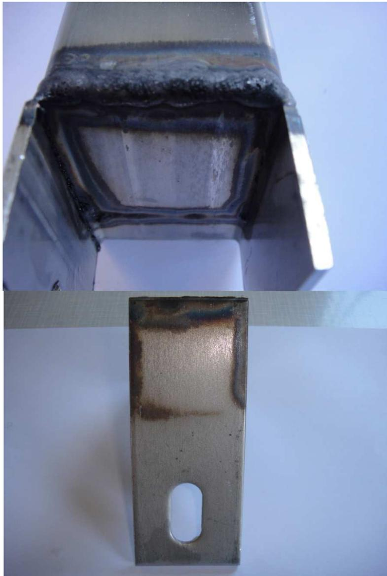
Es ist bereits eine deutliche Verfärbung rund um die Schweißverbindungen festzustellen. Die weiteren Fotos zeigen den direkten Vergleich der Proben aus der Abbildung 8.2, vor und nach dem Auslagerungsversuch.
