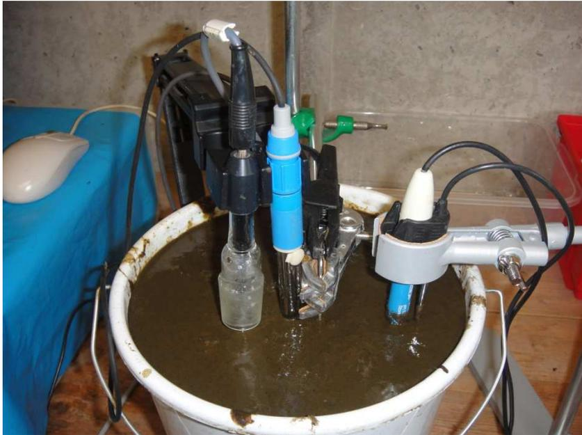
Ist alles eingerichtet, kann die Messung gestartet werden. Die Spannung wird vom Potentiostat aufgezeichnet und über die Software als Kurve auf dem Bildschirm ausgegeben. Zu Beginn der Messung werden die Leitfähigkeit, der pH-Wert und die Temperatur der Biomasse notiert.
