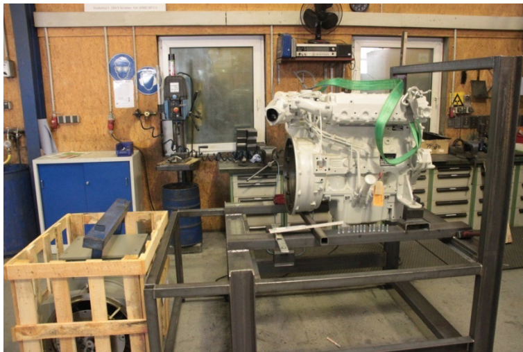
Abbildung 4-1 Montage des Motors
