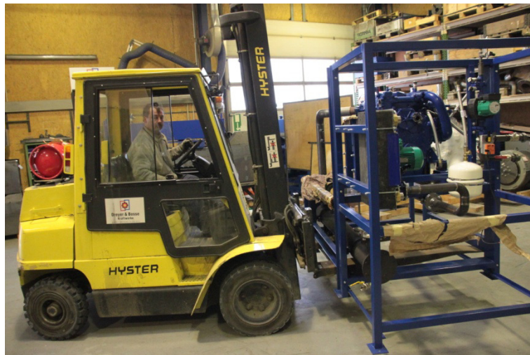
Abbildung 4-4 Verrücken der Anlage mit dem Stapler
