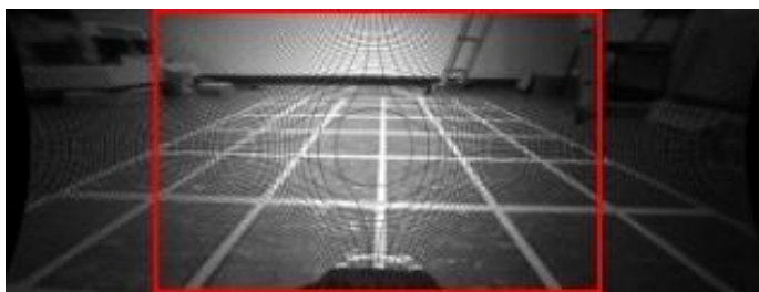
Abb. 1-22: Resultat der Linsenverzeichnungskorrektur. Der rote Rahmen entspricht der gleichen Größe des Bildausschnitts wie in Abb. 1-21
