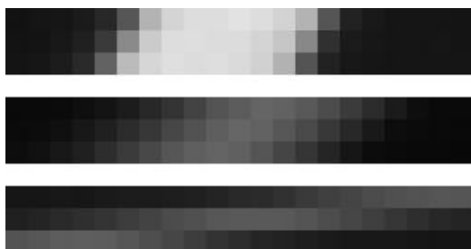
Abb. 1-23: Vergrößerte Bildausschnitte der Fahrbahnmarkierung. Oben: Gerade. Mitte: unscharfer Kurvenabschnitt in ca. 30cm Entfernung. Unten: äußere Kurvenmarkierung in ca. 1,5m Entfernung
