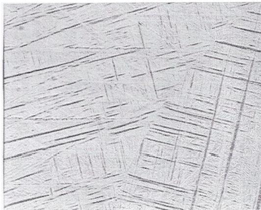
Abbildung 6.61: Ti-6Al-4V oberhalb \vartheta_{\beta} gegläht und in Wasser abgeschreckt, 200x [BOY94]
