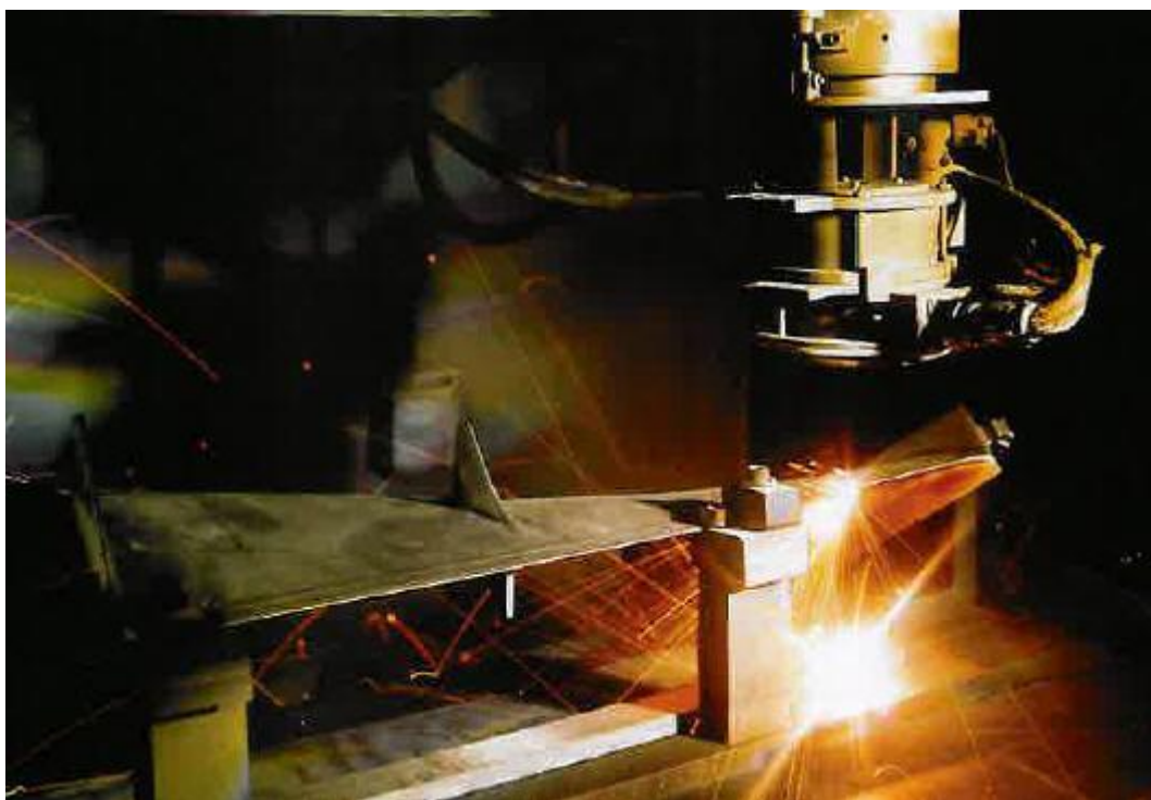
Abbildung 2.20: Laserstrahlschweißen an einem Fan Blade [SCHR10]
