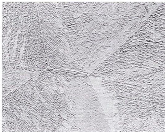
Abbildung 6.13: Ti-6Al-4V oberhalb \vartheta_\beta gegläht und an Luft abgekühlt, 200x [BOY94]
