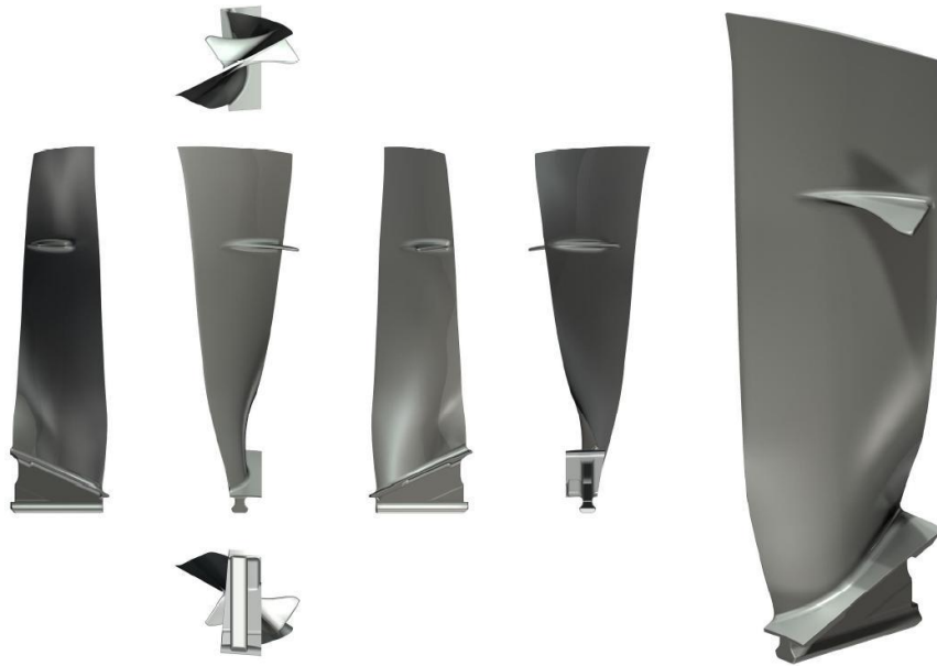
Abbildung 2.4: CAD Modell eines Schaufelprofils des Triebwerks CFM56-5A [FAB09]
