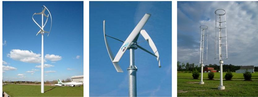
**Abbildung 2: Vertikale Windkraftanlagen** <sup>7</sup>
