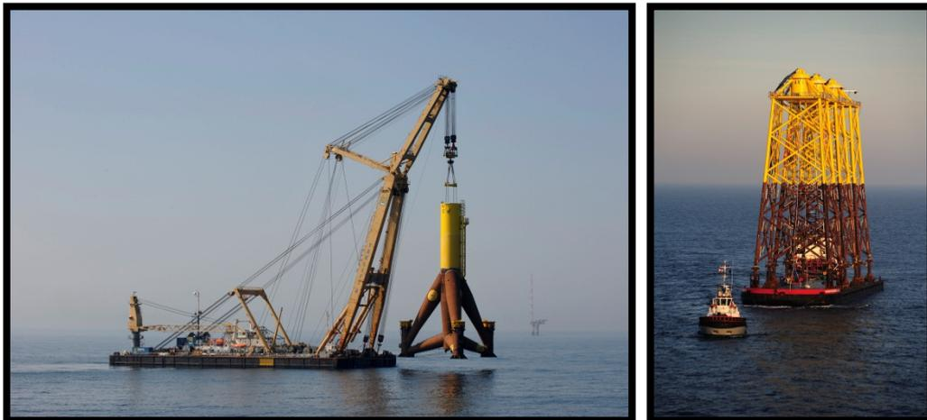
Abbildung 14: Tripod und Jacket Transport
