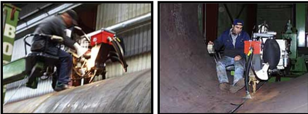
Abbildung 12: Außen und Innen Unterpulverschweißen<sup>35</sup>
