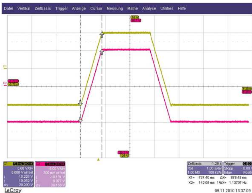
Abbildung 16 – Drehzahlumkehr \pm 3000 \text{ min}^{-1} mit HLG
