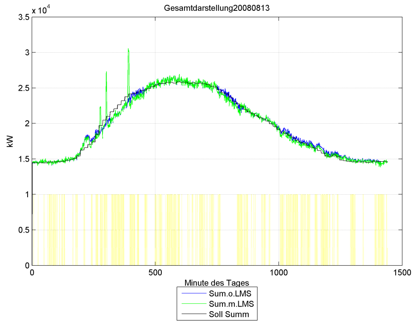
Bild 5.8: Tageslastverlauf des neu implementierten Fuzzy-Reglers
