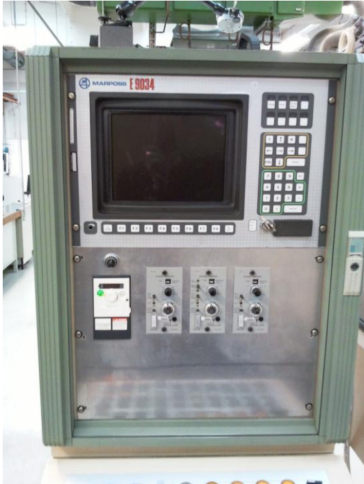
Bild 3.12: Bedienpult mit integrierten Ladungsverstärkern und Frequenzumformer
