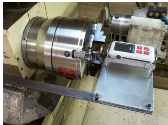
Bild 3.21: Plattform zum Messen eingeschwenkt
