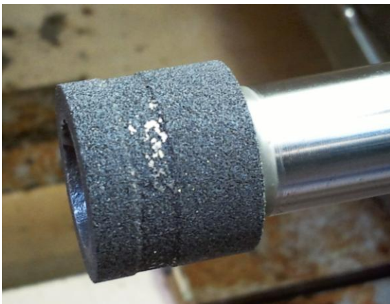
Bild 4.40: Zusetzung Spezifikation 8 [ v_c = 40 m/s v_{fr} = 6 mm/min]
