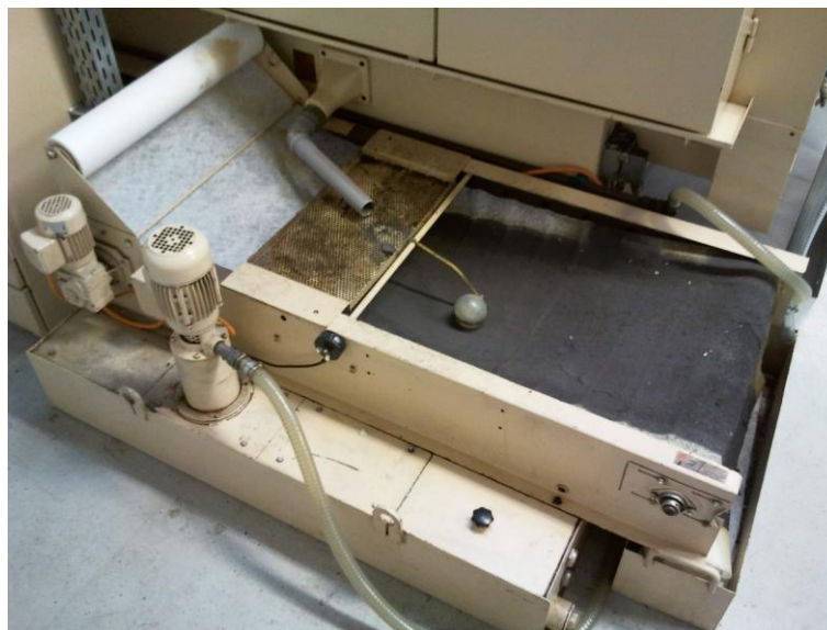
Bild 3.2: Faudi Schwerkraftbandfilter ABF 0,7/700
