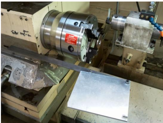
Bild 3.20: Plattform für MarSurf (in Schleifposition geschwenkt)
