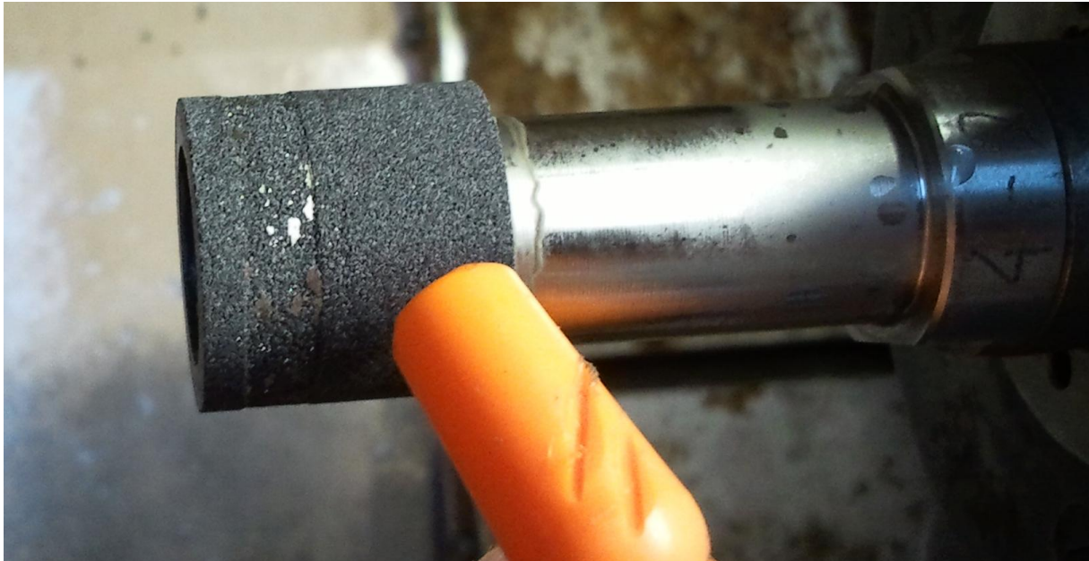
Bild 4.30: Bindungsspezifikation 4 mit Zusetzungen bei Standradkühlung [ v_c = 40 m/s; v_{fr} = 4 mm/min]
