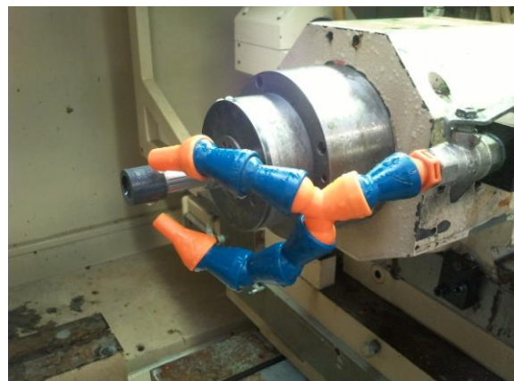
Bild 4.32: Veränderte Kühlung für Spezifikation 4
