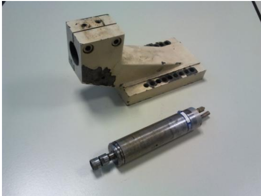
Bild 3.6: IBAG-Abrichtspindel mit Spindelhalter
