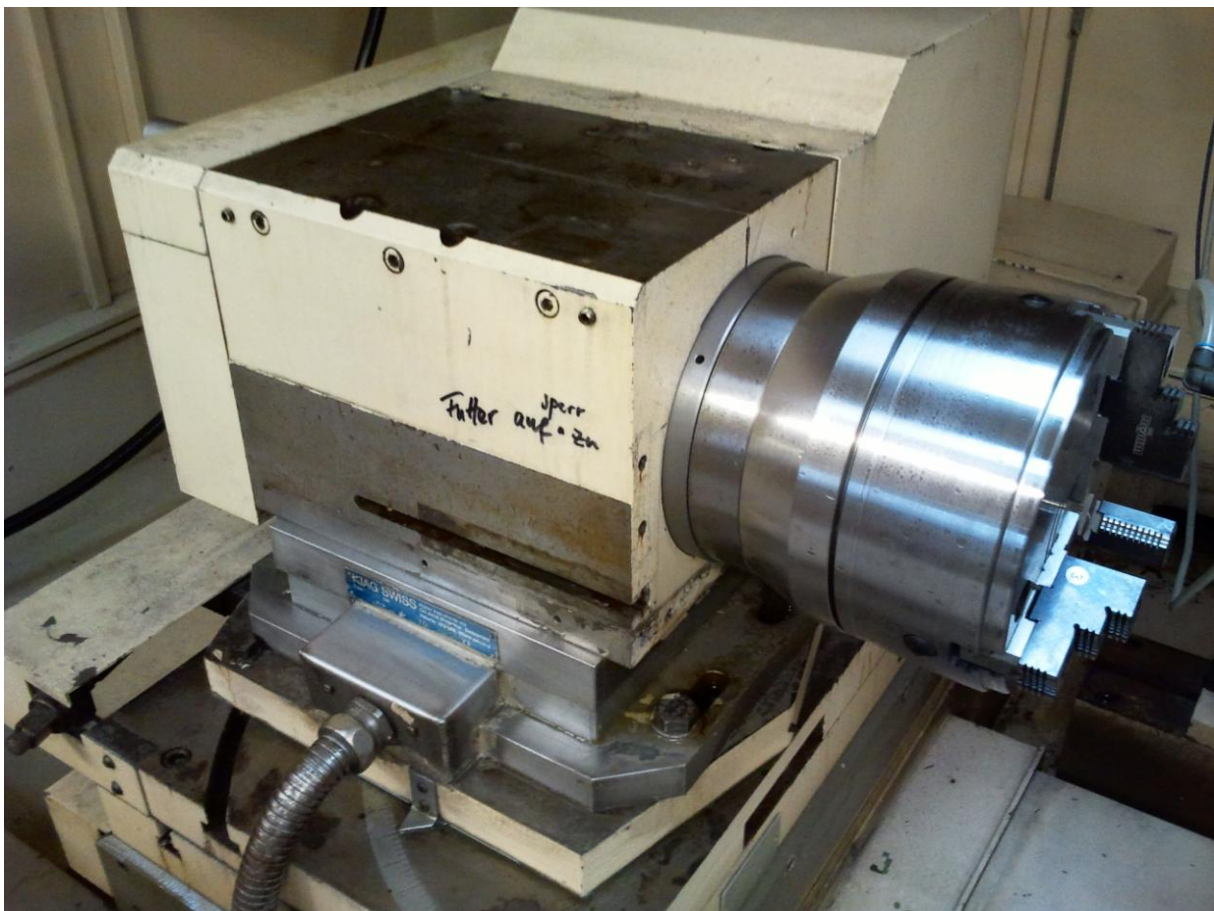
Bild 3.11: Direkt unterhalb der Werkstückspindel montierte Kraftmessplatte, hier ohne Abdeckung gezeigt
