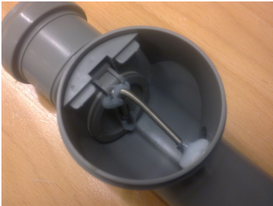
Abbildung 4-27 Rückstauklappe mit nachträglich eingebauter Feder
