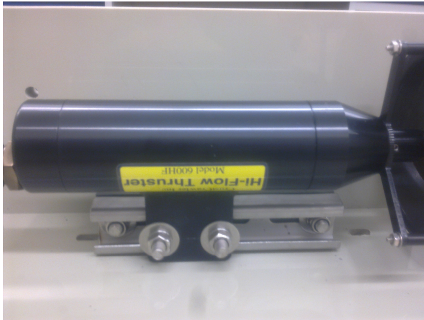
Abbildung 6-14 Befestigung der Pumpe mittels eines C-Profil
