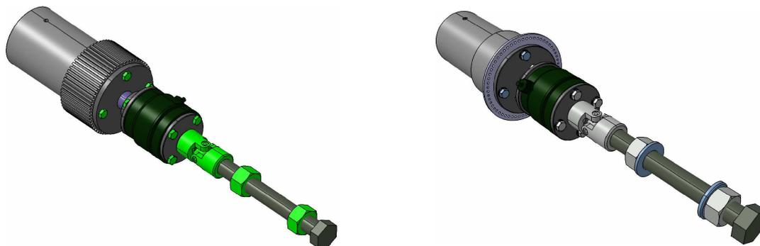
Abbildung 3.5: Aufbau der Axial- und Drehzahlmeseinheit - *krp-004-06-00*
