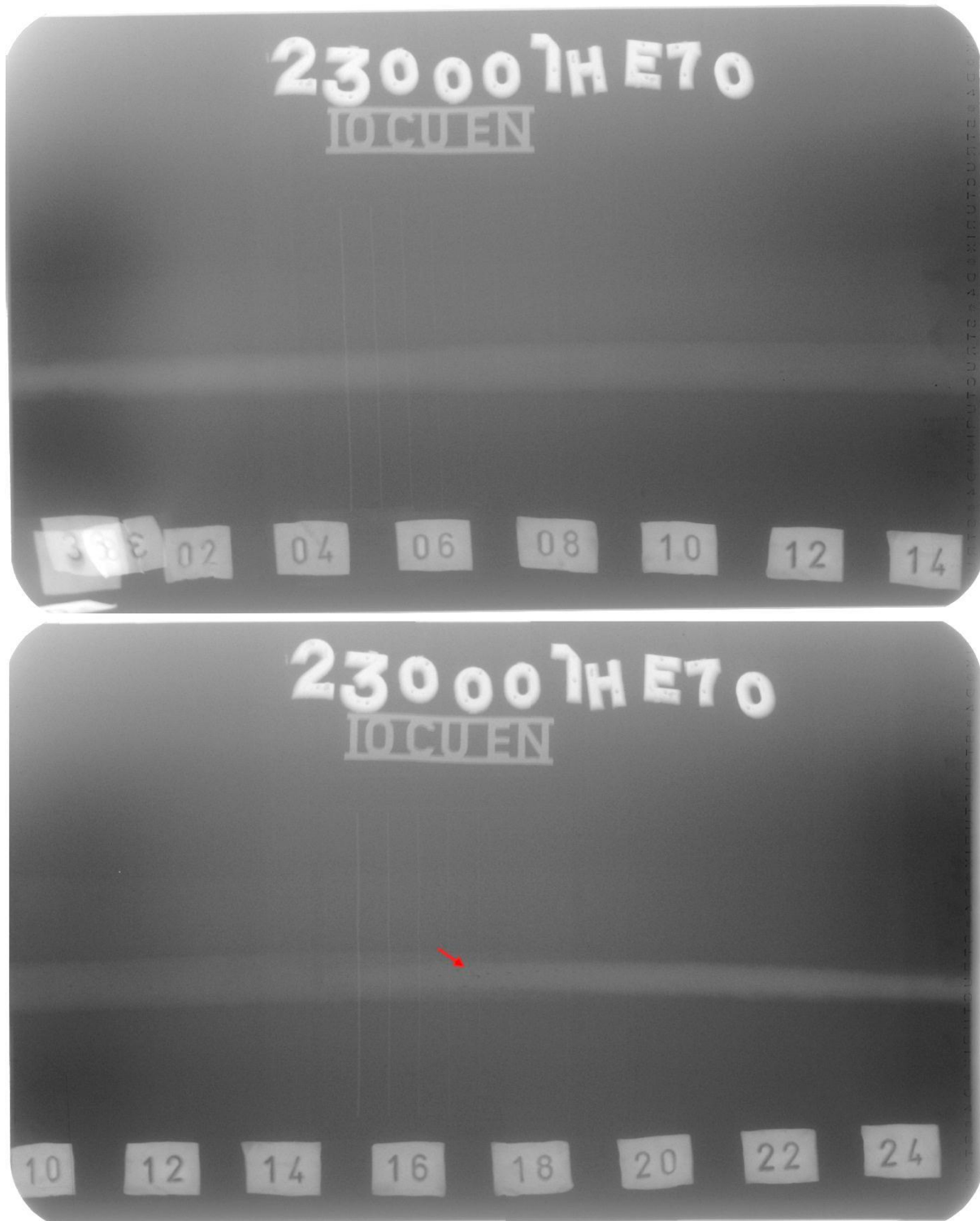
Abbildung 7.9: Röntgenaufnahme Schutzgas 3 (70 % He)
