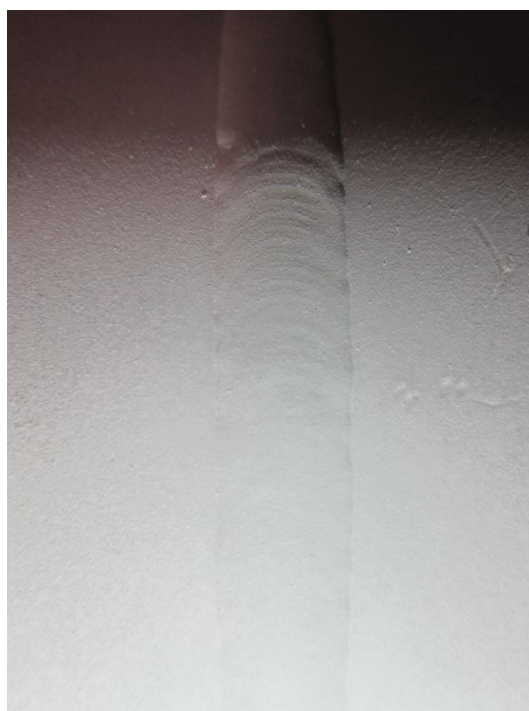
Abbildung 7.6: Farbeindringprüfung Schutzgas 3 (70 % He)
