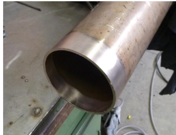
Abbildung 6.1: Nahtvorbereitung, eigene Aufnahme
