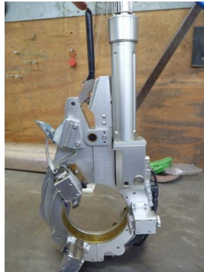
Abbildung 5.2: Schweißkopf Bild 2, eigene Aufnahme
