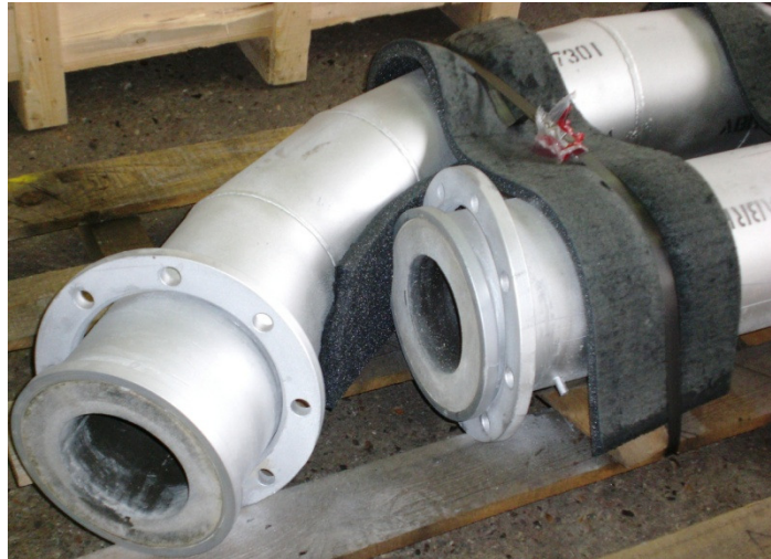
Abbildung 1 – Schnitt durch einen Schmelzbasaltbogen [1.10] - und Fertigungsbeispiel nach Fa. Kalenborn
