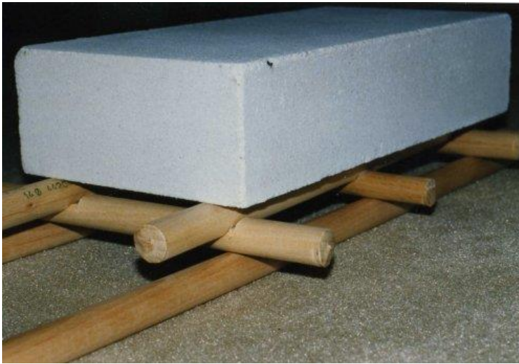
Abb. 4: Schlitten mit Querriegeln auf Schienen 16
