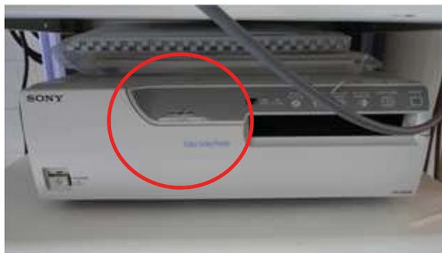
Abb. 5–2: Mechanischer Schaden an einem Videoprinter (Quelle: GPS GmbH)
