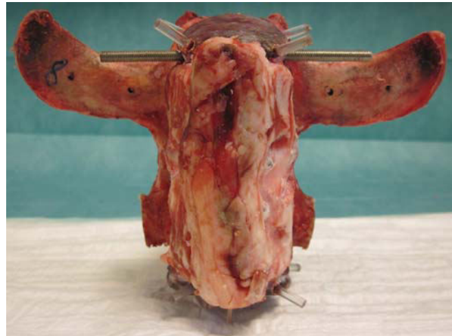
Bild 4.7 Für die Einbettung vorbereitetes Präparat von frontaler Ansicht. Die Kunststoffstifte, die vor Querverdrehungen während der Versuche schützen sollen, sind gesetzt und die Gewindestange ist in der für sie vorgesehenen Bohrung platziert.
