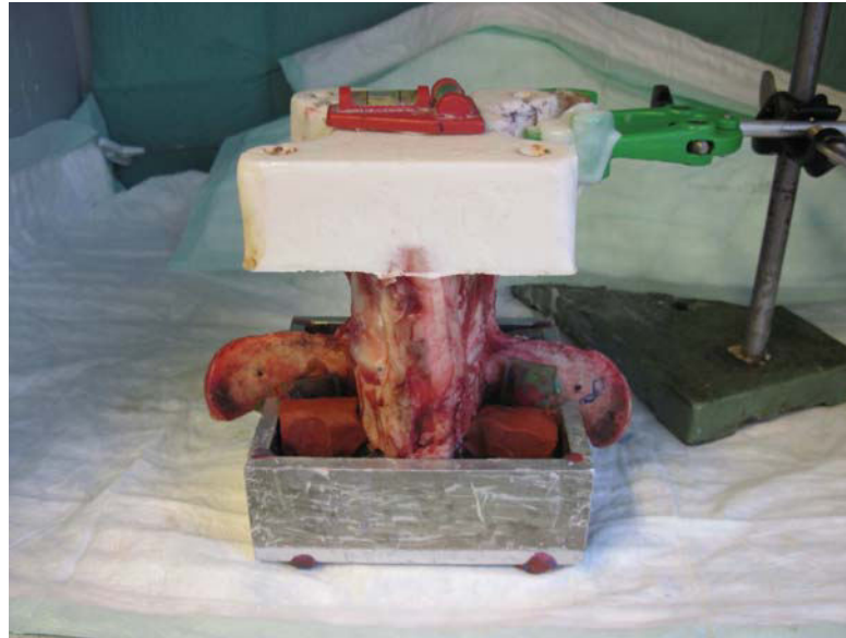
Bild 4.9 Einbettung des oberen Wirbels. Der untere Wirbel ist bereits eingebettet. Mit Hilfe der Wasserwaage auf dem kaudalen Wirbel können die beiden Einbettungen parallel zueinander ausgerichtet werden. Zu sehen ist auch die in roter Knete ummantelte Gewindestange innerhalb der Einbettvorrichtung.
