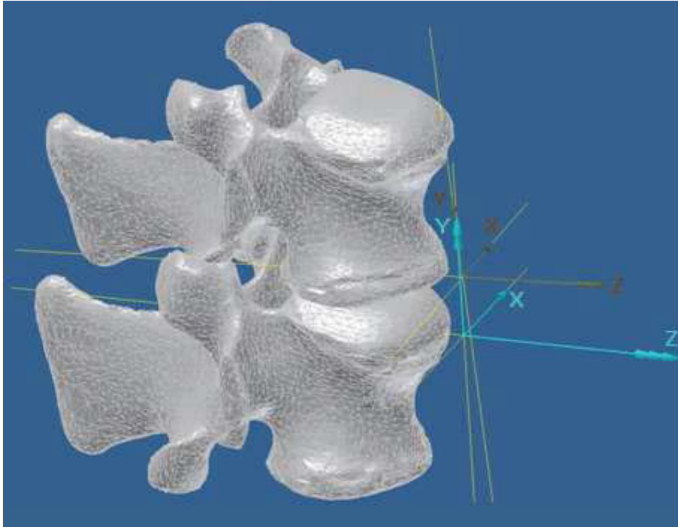
Bild 4.19 Zusehen sind die in Inventor zusammen geführten Wirbel des Präparates 1. Sie sind über ein Gelenk mit sechs Freiheitsgraden verknüpft. Definiert wird dieses Gelenk über die anatomischen Koordinatensysteme (blau des unteren Wirbels, braun des oberen Wirbels), die anhand der zuvor gelegten Achsen über die Mittelpunkte der Marker auf die Wirbel übertragen werden konnten.
