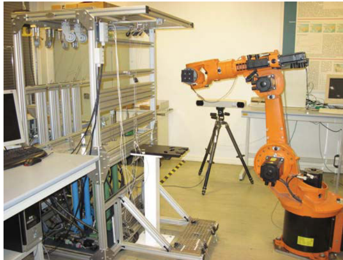
Bild 3.5 Kinemator zur Simulation von Muskelkräften während der Kinematikversuche. Rechts neben dem Kinemator steht der Kuka-Industrieroboter zur Initiierung der Bewegungen auf das zu messende Präparat.
