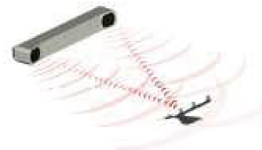
Bild 3.9 Funktionsweise des NDI Systems mit passiven Tools. Der Kamerabalken emittiert IR-Licht, die von dem passiven Tool reflektiert und von dem Kamerabalken wieder aufgenommen werden [NDI11].
