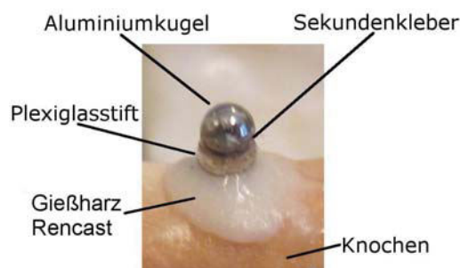
Bild 4.10 Komponenten zur Befestigung der Marker am Knochen. Die Aluminiumkugel wird als Marker mit Sekundenkleber auf dem Plexiglasstift befestigt. Der Plexiglasstift ist wiederum mit dem Drei-Komponenten-Gießharz Rencast im Knochen verankert.
