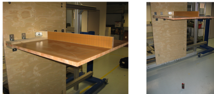
Abbildung 5.26: Links: Versuchsaufbau für Versuchsprobe 4. Rechts: Darstellung einer Messung. Das Messgerät befindet sich auf dem Boden und misst den Abstand zum Messpunkt auf der Unterseite der Versuchsprobe
