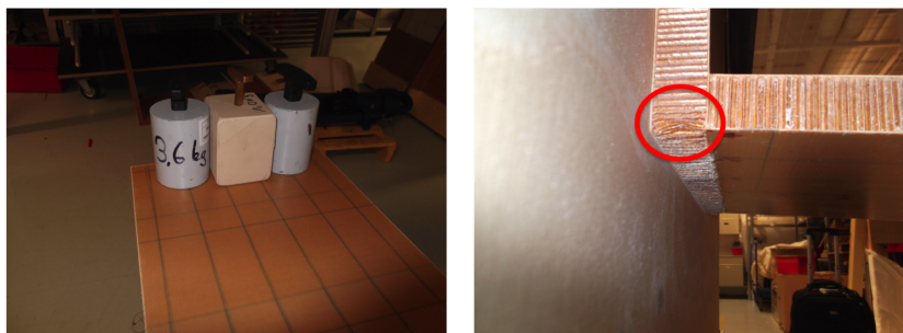
Abbildung 5.19: Versuchsdurchführung mit der ersten Versuchsprobe. Links: Belastung der Versuchsprobe mit 8.2\text{kg} . Rechts: Im markierten Bereich beginnt die Wabe des eingespannten Sandwichpanels zu knittern
