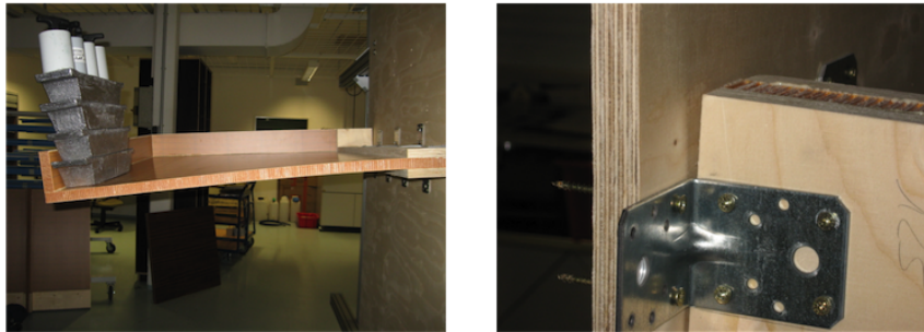
Abbildung 5.25: Links im Bild ist die maximale Belastung der Versuchsprobe 3 gezeigt. Rechts zeigt sich die bei der Belastung entstehende Verformung an der Einspannung (kippen der gesamten Einspannung)
