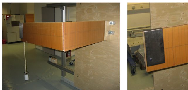
Abbildung 5.21: Darstellung des Versuchsaufbaus für den zweiten Versuch. Links: Versuchsaufbau insgesamt. Rechts: Modifikation der Versuchsprobe zur Einleitung der Lasten
