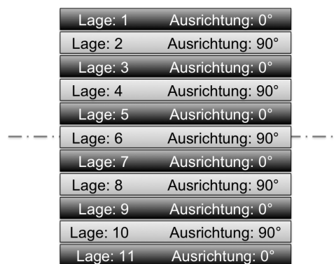
Abbildung 5.17: Schematischer Lagenaufbau der verwendeten Holzverstärkung
