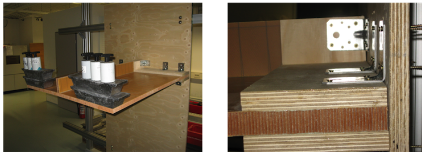
Abbildung 5.27: Die maximale im Versuch verwendete Belastung wird links im Bild gezeigt. Dabei entsteht die rechts im Bild gezeigt Verformung an der Einspannung (kippen der gesamten Einspannung).
