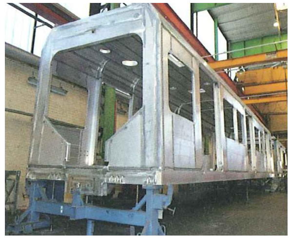
Abb. 1-7 Wagenkasten aus Aluminium, Integralbauweise Foto: [ALSTOM Transport Deutschland GmbH]
