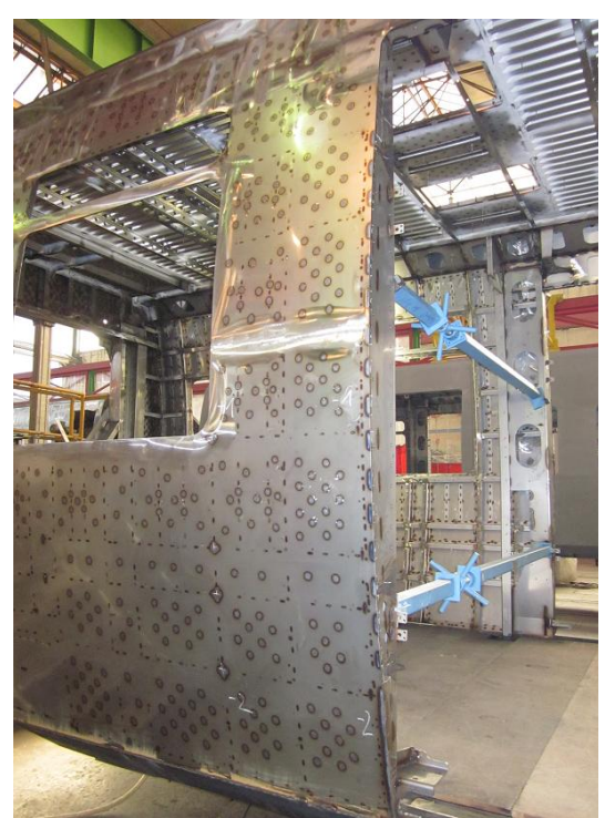
Abb. 1-9 bombierte Seitenwand Foto: [ALSTOM Transport Deutschland GmbH]
