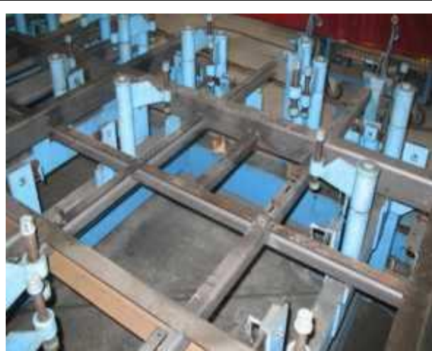
Abb. 1-1 Untergestell in Spannvorrichtung
