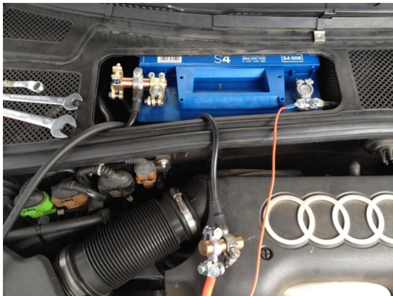
Abbildung 3.16: Anschluss der Starterbatterie am Fahrzeug mit Kupferadapterbolzen und Starterbatterieladeanschlussleitung
