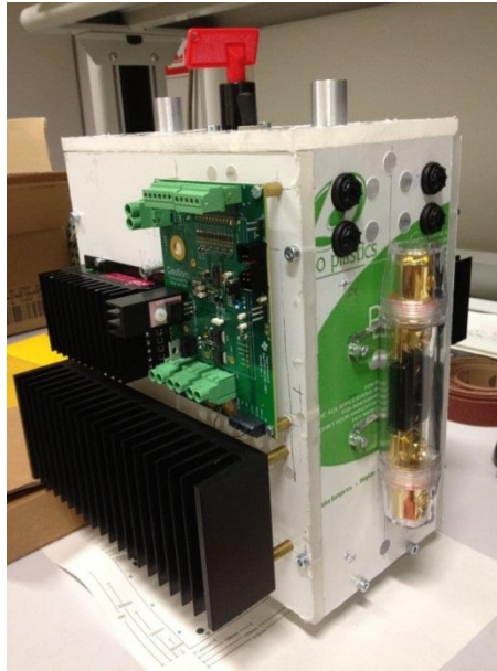
Abbildung 3.3: Gehäuse der Starterbatterie mit positionierten Bauelementen und Batterieanschlusspole
