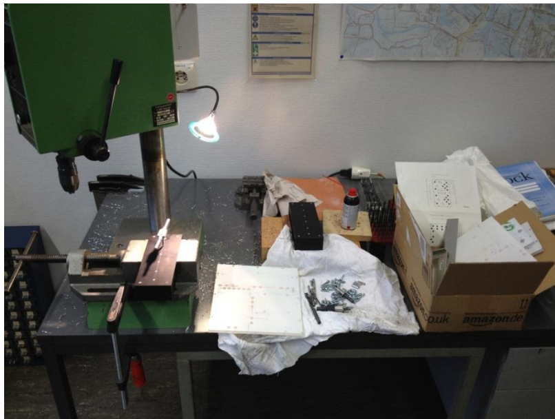
Abbildung 3.2: Bearbeitung der Makrolonplatten und des Kühlkörpers für die Positionierung, Befestigung und Verdrahtung der einzelnen Bauteile und elektronischen Komponenten
