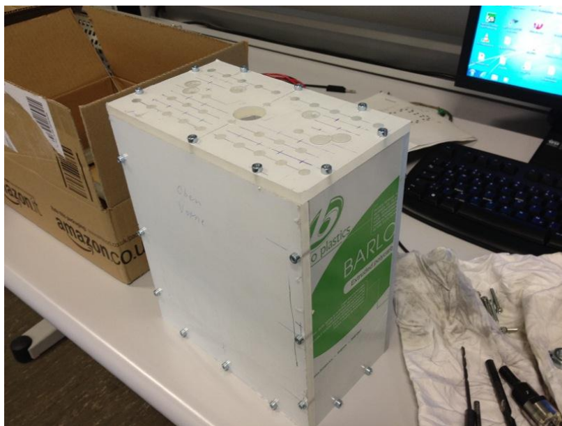
Abbildung 3.1: Überprüfung des Gehäuses und der Gewindebohrungen auf Maßhaltigkeit und Passgenauigkeit
