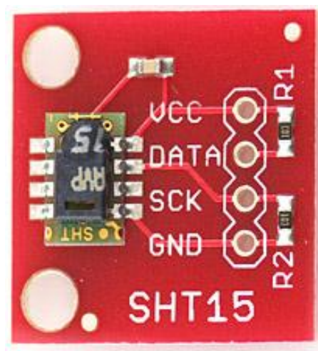
Bild 25: SHT15-Sensor auf einer Trägerplatine [24]
