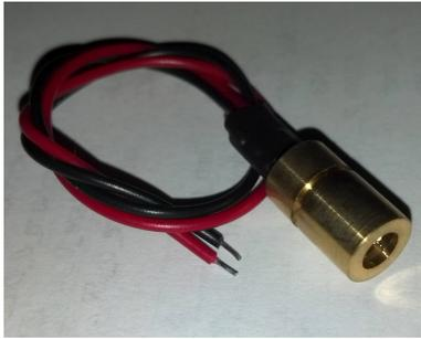
Abbildung 5.4: Laserdiodenmodul
