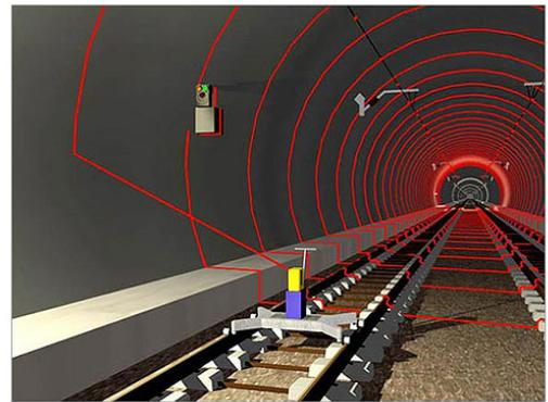
Abbildung 2.6: Vermessung von Tunnelwänden
