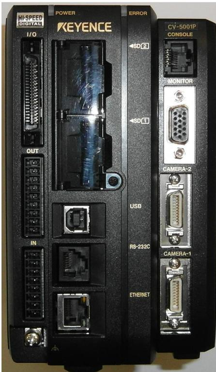
Abbildung 4.14 „Keyence-CV-5001-Auswerteeinheit“
