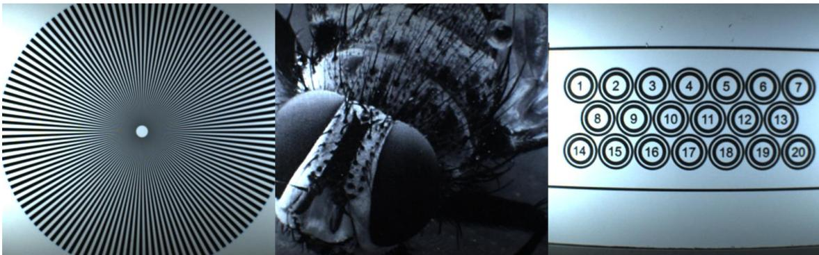
Abbildung 7.28 „Autofokusalgorithmen-Testmotive“
