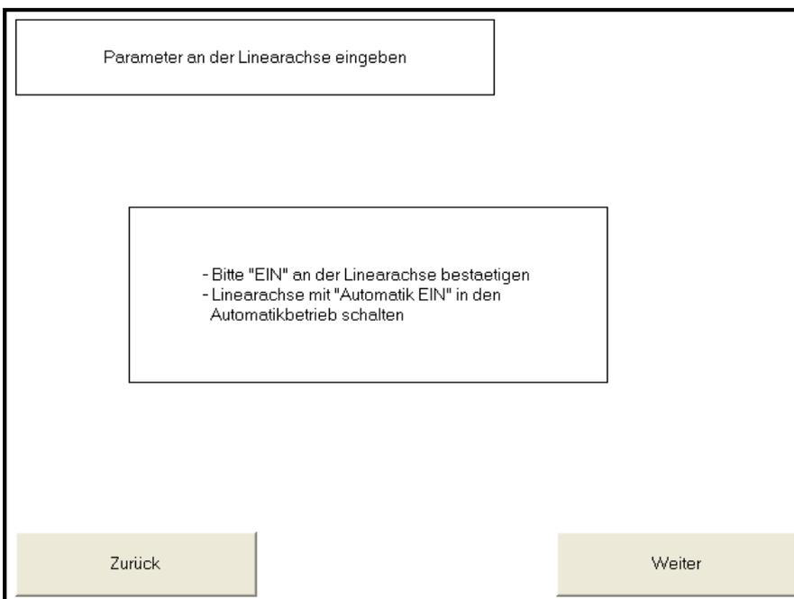
Abbildung 10.45 „Visualisierung: Parameter-Linearachse“
