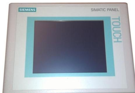
**3-2: HMI Bediengerät TP 177B**
