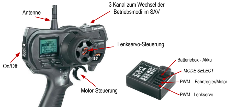
Abbildung B.2 – Lieferumfang der Fernsteueranlage MC30; der ursprünglich zur Kalibrierung und dem Feintuning der Fernsteuerung vorgesehene dritte PWM Kanal wird zum Wechsel der Betriebsart verwendet[18].
