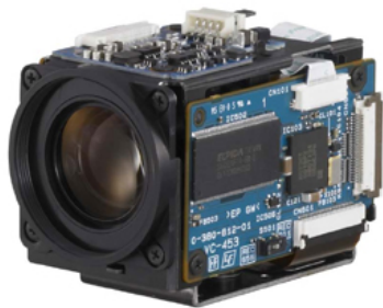
Abbildung B.4 – Die Sony FCB-PV10 CCD Kamera zur Erfassung der Fahrspurmarkierung liefert zusätzlich die Eingangsfrequenz für den CLOCK MANAGER des SAV CONTROL IP-Cores [29].
