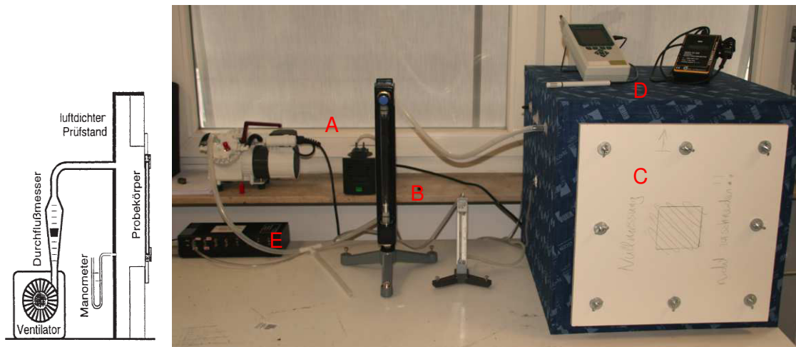
Abbildung 2.3.1: li.: schematischer Versuchsaufbau aus [DIN_EN12114]; re.: Laborversuchsaufbau am Passivhaus Institut (A: Membranvakuum pumpen; B: Schwebekörper-Durchflussmesser; C: Kasten mit Blende; D: Messeinrichtung zur Bestimmung der Umgebungsbedingungen; E: Differenzdruckmessung)
