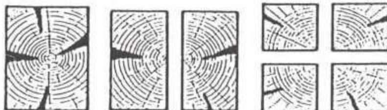
Abbildung 2.2.2: Verlauf von Trockenrissen bei unterschiedlichen Einschnittarten (links.: Vollbalken; Mitte: Halbbalken; rechts: Viertelbalken) (Quelle: [GDHeV])
