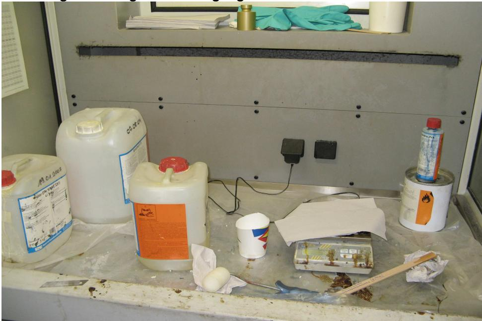
**Abbildung 27: Der Gefahrstoffarbeitsplatz mit Frischluftschleier des Leichtbaulabors der Hochschule für Angewandte Wissenschaften Hamburg**
