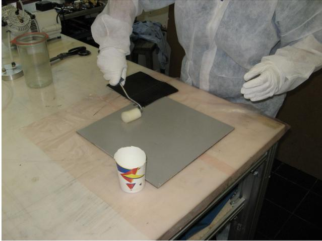
**Abbildung 31: Einstreichen der Unterlage mit dem Trennmittel**
