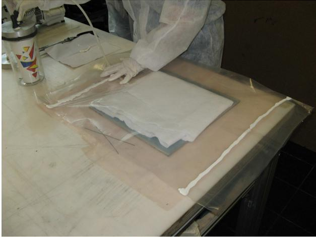
**Abbildung 33: Fasermatten- Lochfolien- Vlies- Sandwich in einer hermetisch verschlossenen Folie mit Vakuumpumpen Anschluss zur Aushärtung des Epoxidformteils**
