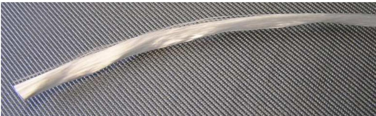
**Abbildung 11: Ein Glasfaserroving besteht aus unverdrehten, gestreckten Fasern**
