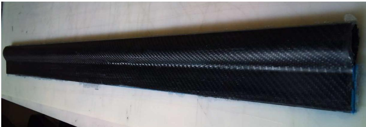
**Abbildung 23 Bauteil, welches durch das Schlauchblas- RTM- Verfahren hergestellt wurde**
