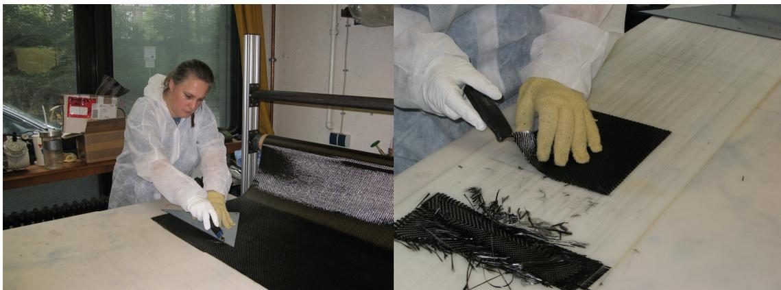
**Abbildung 28: Abtrennen der Fasermatrix von der Rolle und anschließender Zuschnitt**
