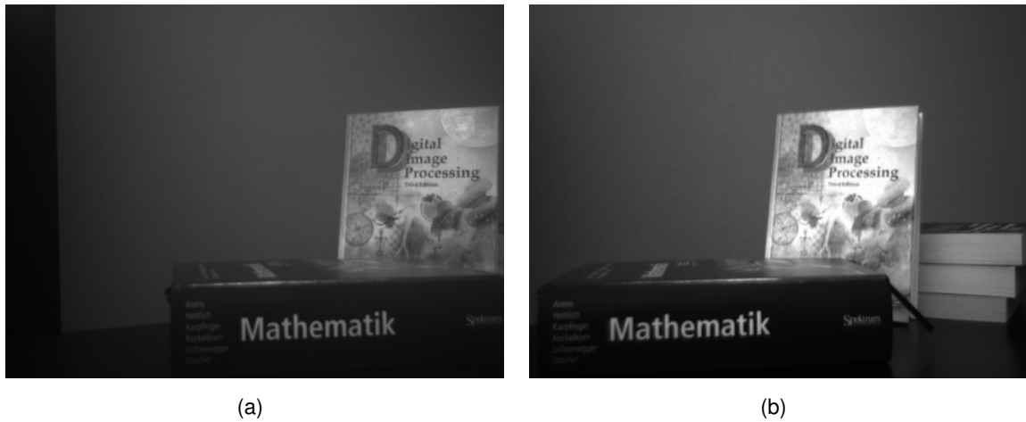
Abbildung 3.10.: Rektifizierte Aufnahmen einer Stereokamera (a) links (b) rechts
