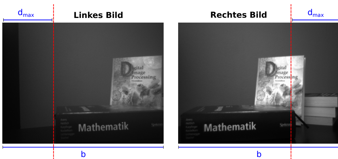
Abbildung 3.20.: Einschränkung der Stereoaufnahme auf den Bereich, der von beiden Kameras erfasst wird
