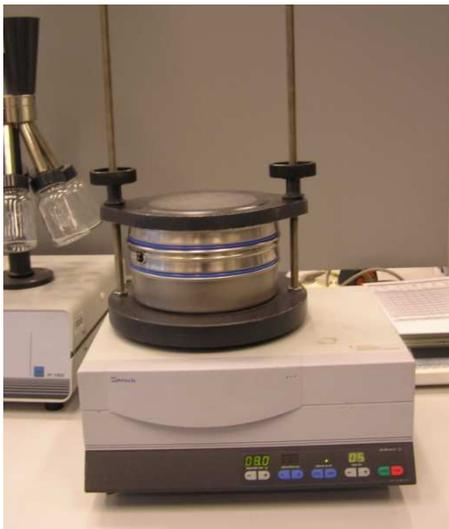
Abb. 29: Siebmaschine AS 200 control „g“
