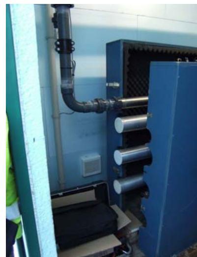
ABBILDUNG 11: ULTRASCHALLGERÄT IM CONTAINER VOR DER BIOGASANLAGE. ZU SEHEN IST LINKS DIE SCHUTZVERKLEIDUNG DES ULTRASCHALLGERÄTES, RECHTS UNTEN DIE PUMPE, DIE DAS SUBSTRAT BEFÖRDERT UND RECHTS OBEN DER KASTEN FÜR DIE ELEKTRONISCHE ANSTEUERUNG. NICHT IM BILD: HINTER DEM STEUERUNGSKASTEN BEFINDEN SICH DIE ULTRASCHALLGENERATOREN (EIGENES FOTO)
